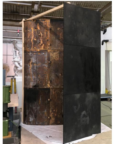
Der Marmor ist in Form von Sand und Kieselsteinen der Grundstoff für den Beton des fünfgeschossigen Marmorbeton-Treppenhauses. Im Scharriren, im Stocken und im Schleifen des Betons wurde – ähnlich wie beim Steinbruch im Berg – etwas von der inneren Schönheit des Treppenhauses preisgegeben.
